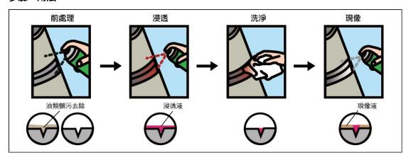
染色渗透探傷法,是讓紅色渗透劑浸透到檢查物的表面缺陷部後,用洗滌劑去除多餘的紅色滲透劑。再用白色顯像劑以應用毛細管現象的原理,發色與顯像出滲透到缺陷的紅色滲透劑,以便輕鬆目視缺陷部位的一種方法。
